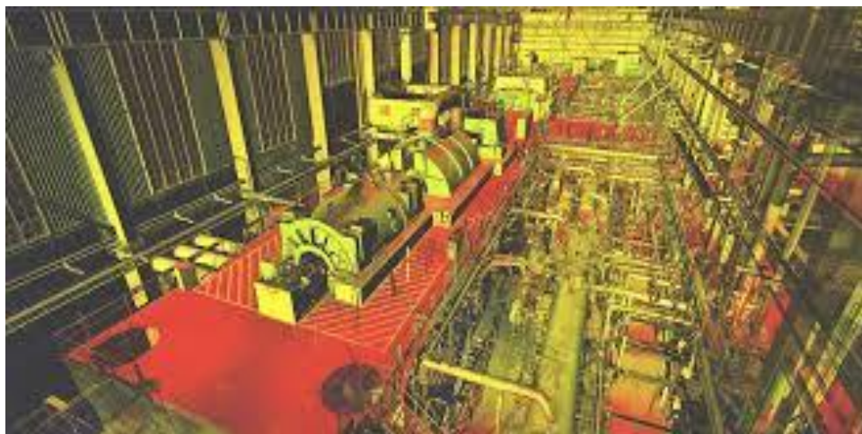
شکل ۲- نمونه ابرنقاط از وضعیت موجود
