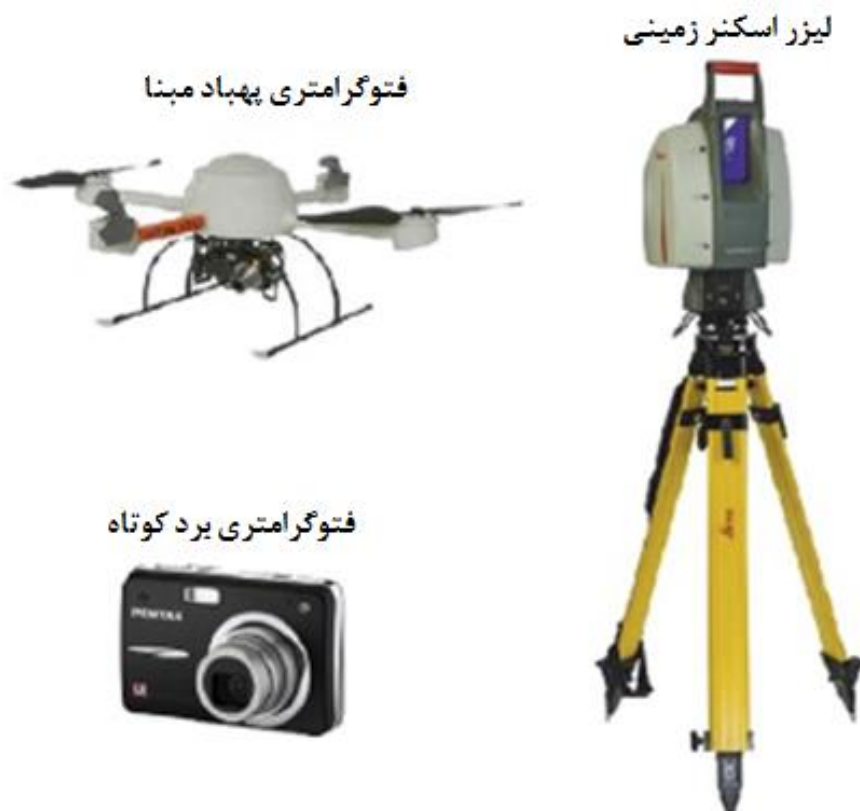
شکل ۲- تلفیق سه روش لیزر اسکنرها
