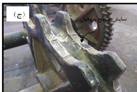
شکل ۷- کاهش طول عمر تجهیزات نقاله میانی ناشی از نیروی زیاد: الف- سایش و لح شدن پین، ب- سایش و کاهش سطح ریل تفلنی و ج- سایش سطح پروفیل چرخ زنجیر.
