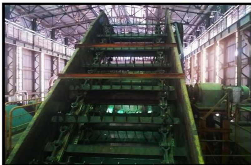
شکل ۱- نقاله میانی برای انتقال باگاس بین آسیاب‌ها در کارخانه کشت و صنعت امام خمینی (ره).
