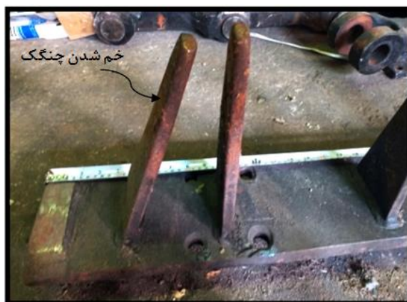
شکل ۶- خم شدن چنگک کناری به علت خیز برداشتن سلت نقاله میانی.
