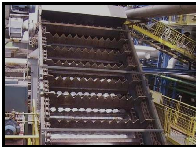
شکل ۱۰- نصب سلت‌های جدید بر روی نوار نقاله میانی آسیاب‌ها.
