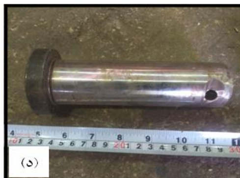
شکل ۵- تجهیزات نقاله میانی: الف- چنگک‌های موجود بر روی سلت، ب- بخشی از زنجیر نقاله، ج- لینک سلت خور زنجیر نقاله که سلت بر روی آن نصب می‌گردد و د- پین که وظیفه اتصال لینک‌ها به همدیگر و انتقال نیرو رو بر عهده دارند.
