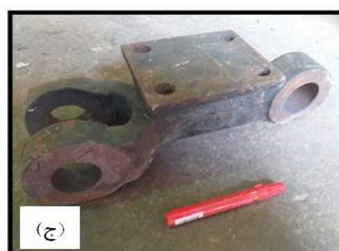
شکل ۵- تجهیزات نقاله میانی: الف- چنگک‌های موجود بر روی سلت، ب- بخشی از زنجیر نقاله، ج- لینک سلت خور زنجیر نقاله که سلت بر روی آن نصب می‌گردد و د- پین که وظیفه اتصال لینک‌ها به همدیگر و انتقال نیرو رو بر عهده دارند.
