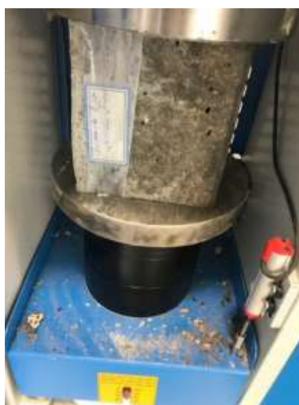
شکل ۵- نمونه ای از بتن با خاکستر پوسته برنج حاوی سنگدانه بازیافتی.
