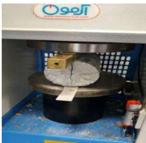
شکل ۸- انجام آزمایش مقاومت فشاری بتن.
