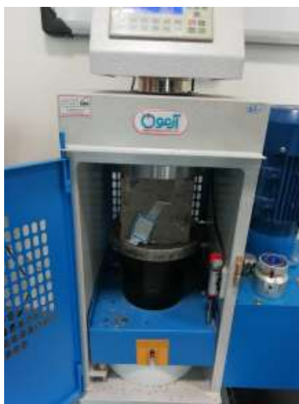
شکل ۳-۷: انجام آزمایش مقاومت فشاری بتن.
