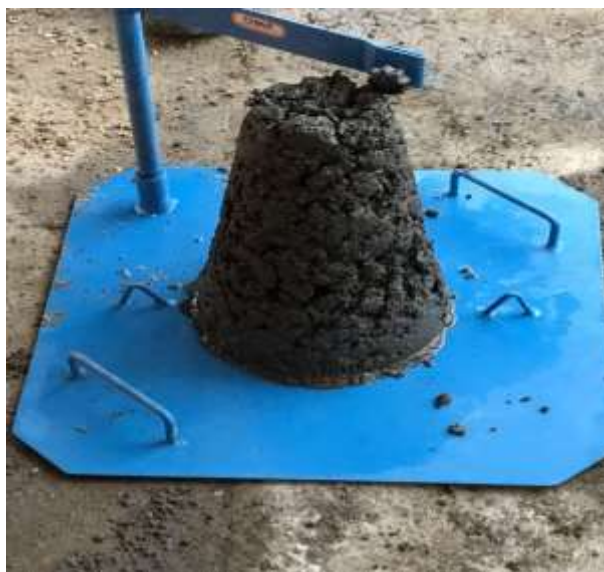
شکل ۶- انجام آزمایش اسلامپ.
