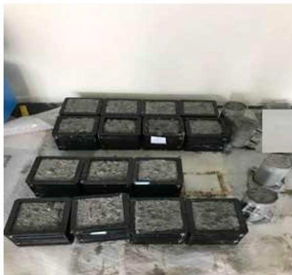
شکل ۴- ساخت نمونه با خاکستر پسته برنج و میکروسیلیس.
