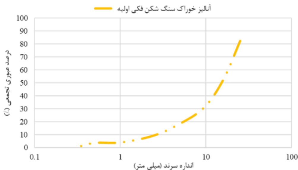
شکل ۱- نمودار توزیع دانه‌بندی نمونه معرف در ابعاد کمتر از ۳۰ میلی‌متر
