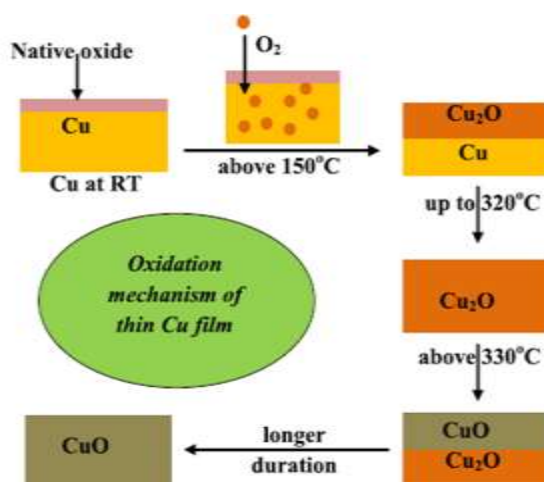
شکل ۲ - رشد فیلم نازک در اثر اکسیداسیون حرارتی [۸]
