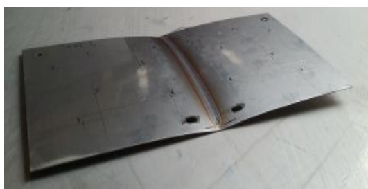
نمونه ورق ۳۰۴ AISI جوشکاری شده در تحقیق حاضر
