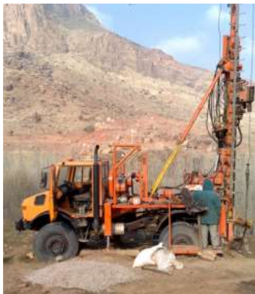
شکل ۵ - نحوه انجام آزمایش لوژان
